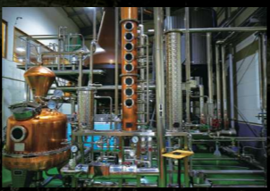
単式蒸留釜と連続式蒸留塔(精留塔)の2つの機能を持つハイブリッド型蒸留機。さまざまなスピリッツの製造が可能。
