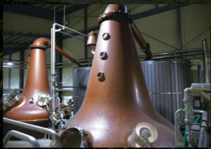
三宅製作所に依頼したポット STILLは小ぶりのオニオン型。下向きのアームによってヘビーな酒質に。
