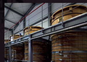
カナダ産ベイツ(ダグラスファー)の発酵槽。保温性に優れ、木桶に棲む微生物の働きが原酒の風味に良い影響を与えます。
