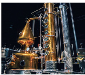
銅製スチルに銅製コラム塔を取り付けた 独自のハイブリッド蒸留器。
