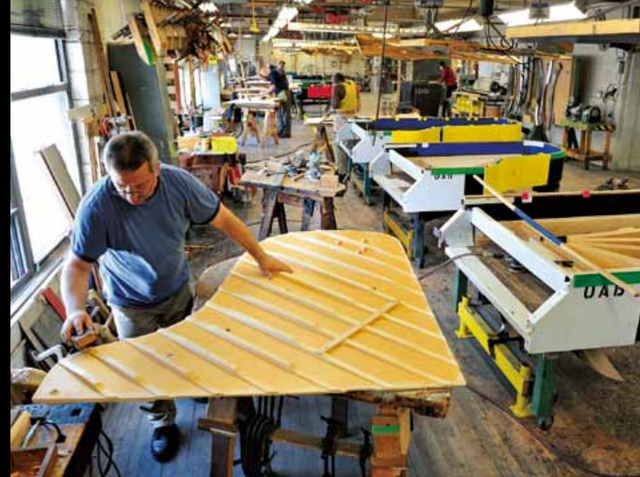
(右) クイーンズ・アストリア地区にある工場。この一角に“スタインウェイ村”が築かれた。(左) ピアノの心臓部である響板の製作。職人が行う手作業は100年以上前から変わらない光景だ。
